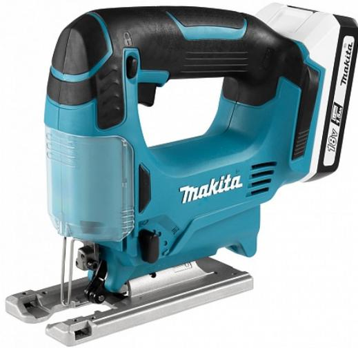
Мощный лобзик с 3 настройками орбиты и диском контроля переменной скорости, что позволяет достичь скорости хода в диапазоне 0–2900 об/мин. Длина хода 18 мм, глубина распила 65 мм по дереву и 6 мм по стали. Поставляется с двумя аккумуляторами 1,5 А·ч и зарядным устройством в кейсе.
