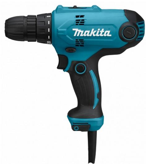
Компактная дрель-шуруповерт с двухскоростным редуктором. 20 положений выбора крутящего момента. 2-х ступенчатая передача (высокая и низкая скорость вращения). Крутящий момент 56 Нм для выполнения широкого спектра работ. Быстрозажимной патрон.
