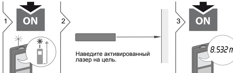
**i** Целевые поверхности: Ошибки при измерениях могут возникнуть в случае выполнения измерений до таких поверхностей, как бесцветные жидкости, стекло, стирофон, матовые полупроницаемые поверхности или при наведении на очень блестящие поверхности. При наведении на темные поверхности время измерения увеличивается.
