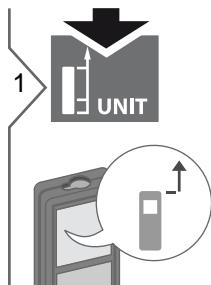
Расстояние измеряется от передней поверхности прибора.
