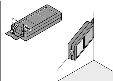
**i** Положение позиционной скобы определяется автоматически и соответственно устанавливается начало отсчета.
