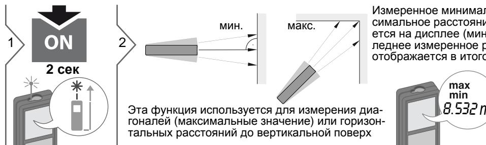
Измеренное минимальное и максимальное расстояние отображаются на дисплее (мин, макс). Последнее измеренное расстояние отображается в итоговой строке.
